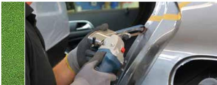
Las bandas abrasivas 2511 siabite han sido desarrolladas especialmente para las lengüetas lijadoras y, gracias al efecto de autoafilado del grano cerámico, permiten la mejor eficiencia posible con aceros de alta aleación y metales difíciles de mecanizar.
