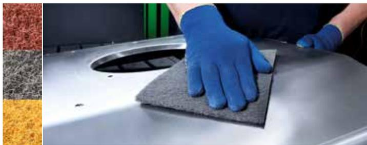
6120 siafleece speed se puede utilizar en el lijado en húmedo y seco y conviene por su alta capacidad de adaptación a la forma, un rendimiento uniforme a lo largo de toda la vida útil, una baja tendencia al embotamiento y una alta calidad de la superficie.
