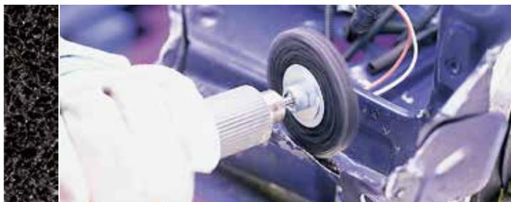
6300 siastrip para acero no aleado y acero de baja aleación cumple todas las expectativas en cuanto a capacidad de abrasión y vida útil, destacando además por su escaso embotamiento.
